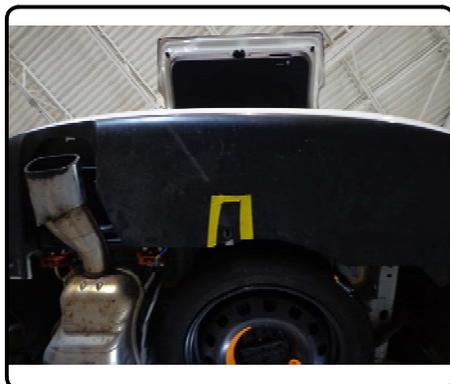
GROSS LOAD CAPACITY WHEN USED AS A WEIGHT CARRYING HITCH: 2,000 LBS. TRAILER WEIGHT & 200 LBS. TONGUE WEIGHT.
