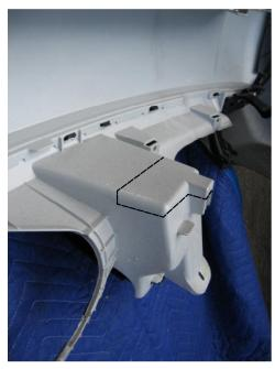
MARK OUT THE INNER BUMPER BEAM AS SHOWN TO THE LEFT.
