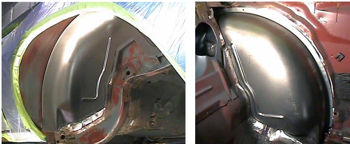
Figure 15 - Test Fit Detroit Speed Mini Tub
