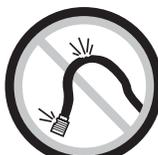
Las mangueras podrán causarle una lesión grave. Revise siempre que las mangueras y sus accesorios no estén dañados, raídos ni flojos y cámbielos inmediatamente. No use coples de desconexión rápida en esta herramienta. Consulte en las instrucciones los preparativos correctivos.
