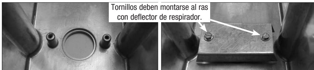
Figura 1 - instalación de Deflectores de Respiraderos Asegúrese de usar fijador de roscas o silicona en las roscas de los tornillos para evitar que se afloje con el tiempo.
