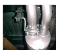
INSTALL REAR MUFFLER HANGER # I ONTO DRIVER SIDE OUTLET OF THE MUFFLER AND INSERT THE WELDED HANGER INTO RUBBER GROMMET.
