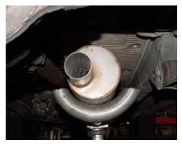
INSTALL MUFFLER #A ONTO STOCK HEADPIPE. OUTLET SHOULD BE AT THE 9 O'CLOCK POSITION. USE A JACK STAND TO SUPPORT THE MUFFLER. YOU WILL USE CLAMP #D TO SECURE THE MUFFLER TO THE STOCK PIPE. DO NOT TIGHTEN. MUFFLER INLET IS LOOKING INTO THE LOUVERS.
