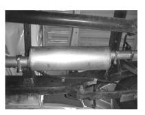
SLIP MUFFLER #B ONTO
