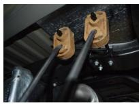
4. INSTALL OVERAXLE TAILPIPE # C INTO THE OUTLET OF THE MUFFLER 1½" TO 2". INSERT WELDED HANGERS INTO THE FACTORY RUBBER GROMMET. USE CLAMP #E TO ATTACH THE OVERAXLE PIPE TO THE MUFFLER OUTLET. DO NOT TIGHTEN.
