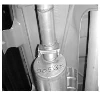
NOW, INSTALL THE HEADPIPE #A ON TO THE FACTORY FLANGE USING FLANGE #F. DO NOT TIGHTEN. INSTALL THE MUFFLER # B WITH INLET FACING FORWARD. MUFFLER INLET IS LOOKING INTO THE LOUVERS. THE MUFFLER OUTLET WILL BE POSITIONED AT ABOUT 6 O'CLOCK.
