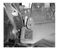
1. UN-BOLT THE FACTORY EXHAUST IN FRONT OF THE FACTORY MUFFLER. FOR EASIER INSTALLATION CUT THE FACTORY TAILPIPE BEHIND THE MUFFLER AND USE A HACKSAW TO REMOVE THE MUFFLER AND HEADPIPE. NEXT REMOVE THE FACTORY REAR HANGER UNDERNEATH THE BUMPER. LEAVE ALL OTHER FACTORY RUBBER GROMMETS IN PLACE.
