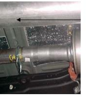
MAKE SURE YOU AT LEAST A 1" CLEARANCE AWAY FROM ALL BRAKE LINES, FUEL LINES, SHOCKS, TIRES, ETC.
