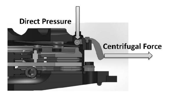
CLAMP LOAD NO LEVERS VS CENTRIFUGAL-ASSIST
