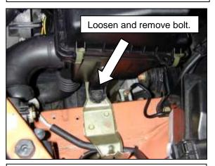
e. Loosen and remove bolt.
