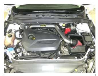
AEM INTAKE SYSTEM INSTALLED.
