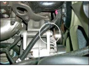
18. Remove the upper alternator bolt.
