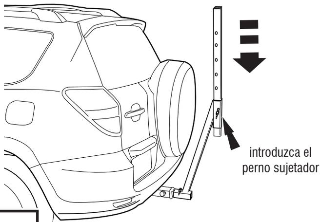
Instalar la barra T en el tubo de apoyo primario. Asegurar la posición con el perno sujetador.
