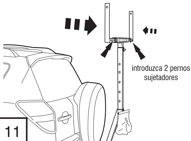
Ajustar la altura del tubo de apoyo primario conforme sea necesario para alinear con la altura del techo. Colocar la bandera de seguridad y fijar la posición con el perno sujetador.
