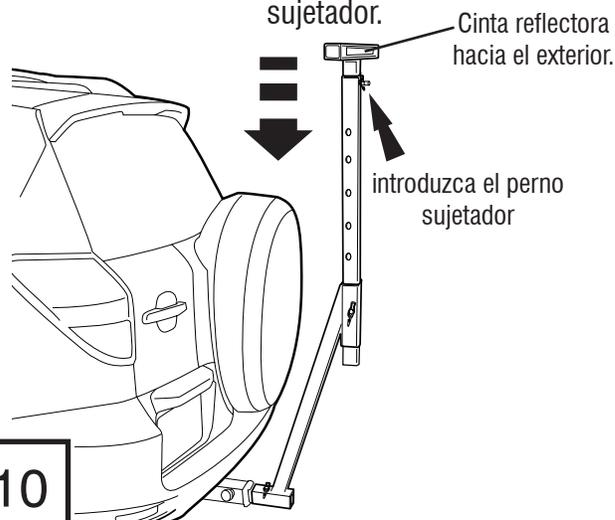
Instale los brazos en la barra T. Asegurar la posición con 2 pernos sujetadores.
