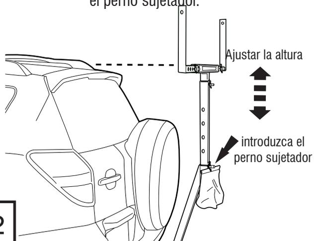
**ADVERTENCIA:** No bloquee las luces traseras de posición, de frenado ni de giro. Siempre coloque la barra T con cinta reflectora hacia el exterior. No utilizar al anochecer o con condiciones de luz baja.
