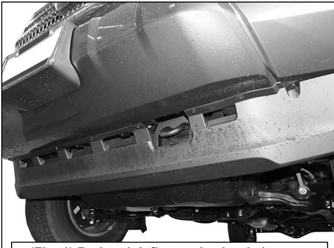
(Fig. 1) Retire el deflector de aire de la parte inferior del parachoques
