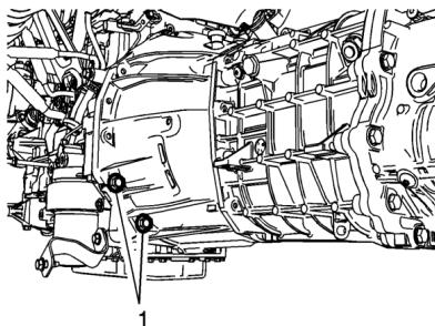
8. Instale los pernos y pasadores del alojamiento del embrague de la transmisión superior al motor (1) y apriete a **50 NM (37 lbs pie)**.
