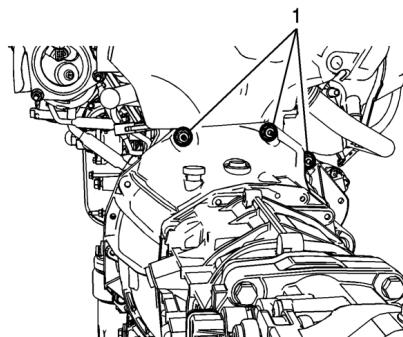
9. Fabriquer et poser la monture de boîte de vitesses. La monture n'est pas incluse car cette pièce est unique en fonction de l'application du client. La pièce illustrée ci-dessous pour référence est issue d'une Cadillac ATS 2015. Quatre boulons n/p 11562426 M10x1,0x30 mm sont offerts pour la commodité du client. Le couple est de **58 Nm (43 lb pi)**.
