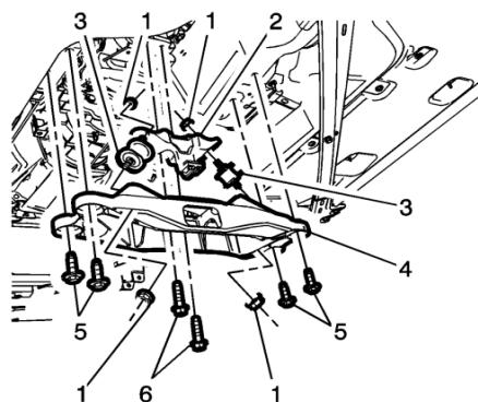
10. Conecte el cilindro maestro del embrague 24251197 a la manguera del actuador del embrague.
