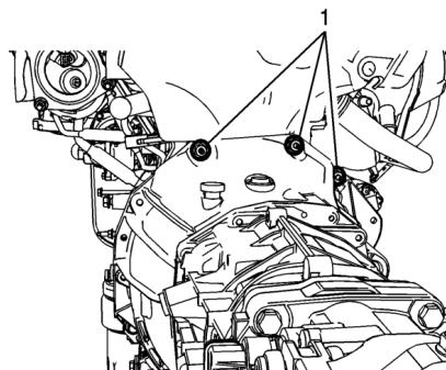
9. Fabrique e instale el montaje de la transmisión. El montaje no se incluye ya que esta parte es única para la aplicación del cliente. La parte mostrada a continuación para referencia pertenece a un Cadillac ATS 2015. Se incluyen cuatro pernos No. de parte 11562426 M10x1.0x30 mm para conveniencia del cliente. Es apriete es de **58NM (43 lbs pie)**.
