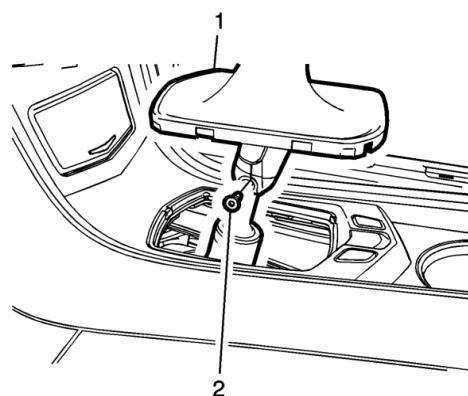
6. Poser le bouton de commande de sélection 24265701 à l'aide de la vis 11571034 serrée à 7 Nm (62 lb po). Du frein-filet doit être utilisé sur cette fixation. Remarque : le soufflet du sélecteur est intégré au pommeau du sélecteur et le client a le choix de l'intégrer ou non à l'application. L'illustration montre la console de la Cadillac ATS 2015 pour référence.
