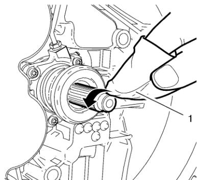
4. Coloque la transmisión al vehículo usando los pasadores de alineación en la parte trasera del motor. Asegúrese de instalar todos los pernos holgadamente antes del apriete final para asegurar que la transmisión esté alineada adecuadamente y apriete al motor. No use los pernos para insertar la transmisión al motor.
