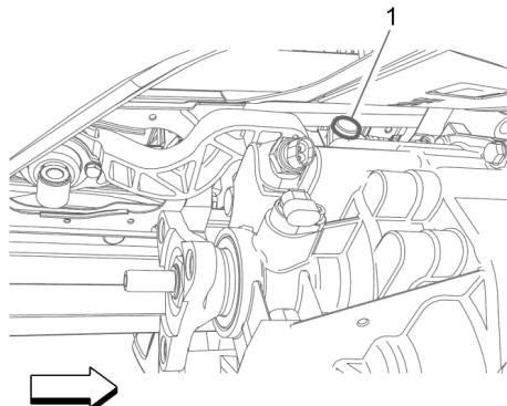
2. Poser l'axe de la barre droite de l'ensemble de commande de sélection 24260856 (1).
