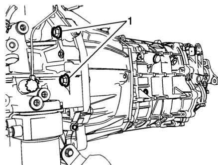
7. Poser les deux fixations (1) inférieures droites (côté boîte de vitesses) fixant le carter d'embrayage de boîte de vitesses au moteur et les serrer à **50 Nm (37 lb pi)**.
