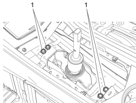
5. Quatre fixations 11562426 sont fournies (1) pour attacher l'ensemble de commande de sélection à la carrosserie du véhicule si le client le souhaite. L'illustration montre la fixation d'un véhicule série au tunnel de transmission. Le couple de serrage du boulon est de **18 Nm (13 lb pi)**
