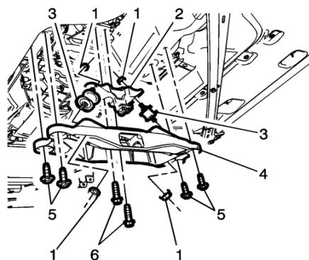
10. Raccorder le maître-cylindre l'embrayage 24251197 au flexible d'actionneur d'embrayage.
