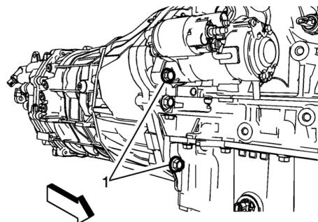
6. Poser les deux fixations (1) inférieures gauches fixant le carter d'embrayage de boîte de vitesses au moteur et les serrer à **50 Nm (37 lb pi)**.
