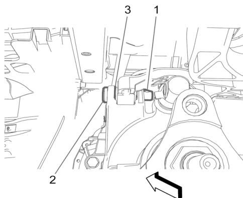
3. Poser l'axe de la barre gauche de l'ensemble de commande de sélection 24260856 (2).
