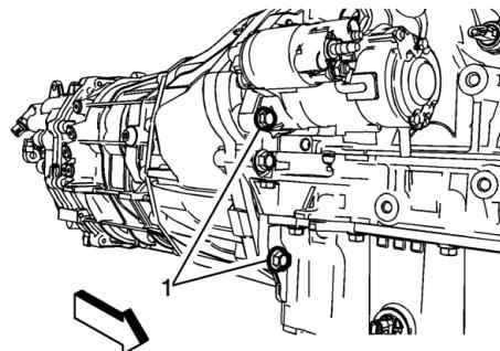
6. Instale los dos sujetadores del alojamiento del embrague de la transmisión inferior izquierda al motor (1) y apriete a **50 NM (37 lbs pie)**.
