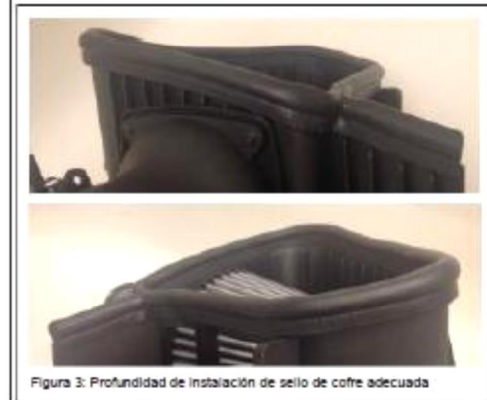
Figura 3: Profundidad de instalación de sello de cofre adecuada
