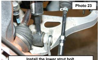
Install the lower strut bolt.
