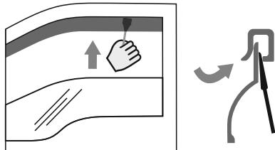
8. Pour assurer une meilleure installation du déflecteur et une meilleure adhérence entre le ruban et la surface du joint en caoutchouc, il est vivement recommandé d'utiliser la lame en plastique en la déplaçant lentement entre le joint en caoutchouc intérieur de la fenêtre et le déflecteur.
