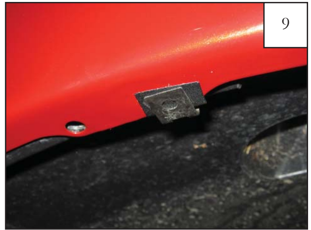
9 Install Clip (CL1-0022) over Tab (MT1-0014).
