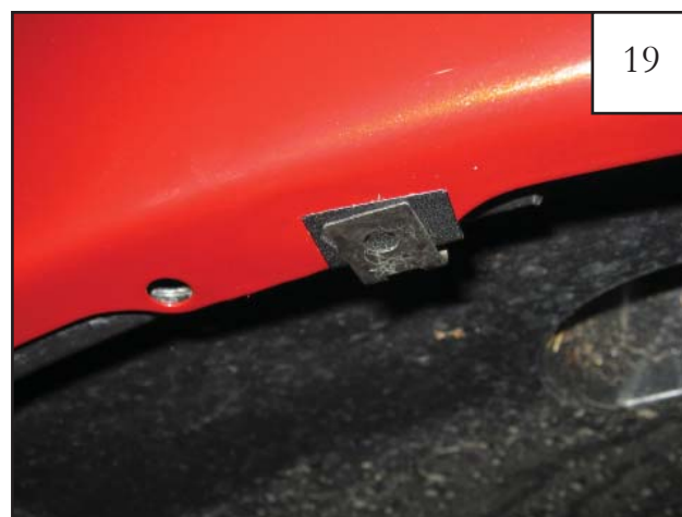
Install Clip (CL1-0022) over Tab (MT1-0014).
