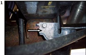
1) ILLUSTRATION 1 SHOWING THE PARKING BRAKE BRACKET ATTACHED TO THE LEAF SPRING PERCH, WITH ONE FLANGE HEAD HEX SCREW THAT <u>WILL</u> BE RE USED TO ATTACH OUR BRACKET.
