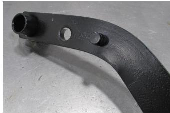
Figure 2a - Remove Pedal Stud
