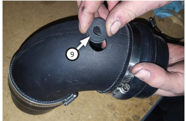
2. Deburr hole then install **grommet (9)**.
