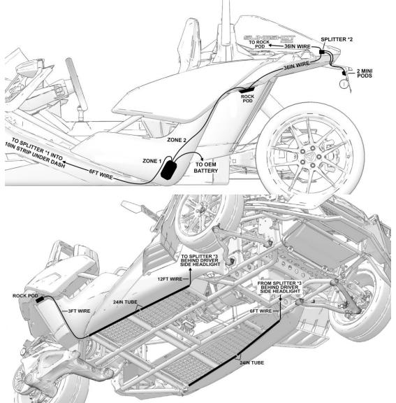
ZONE 1- 2PC 10IN STRIPS UNDER DASH, 2 ROCK PODS, 24IN TUBE BEHIND GRILL ZONE 2- 5PC 10IN STRIPS ON BUMPER, 4PC 24IN TUBES UNDERGLOW, REAR LIGHTS
