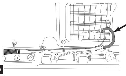
**PULL BRAKE LIGHT AND CAMERA WIRE HARNESS** OUT OF TAILGATE AND **REROUTE HARNESS** THROUGH VENT
