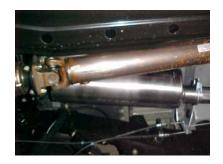
INSTALL THE MUFFLER ONTO THE HEADPIPE
