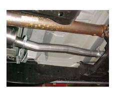
INSTALL THE HEADPIPE #A. USE CLAMP #F TO SECURE HEADPIPE TO FACTORY PIPE. DO NOT TIGHTEN. YOU WILL NOT USE THE FACTORY FRONT HANGER WITH THE GIBSON SYSTEM
