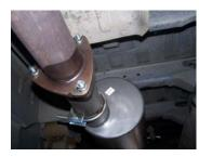
SLIDE MUFFLER ONTO THE FRONT HEADPIPE WITH THE INLET TOWARDS THE CONVERTER (MUFFLER INLET IS LOOKING INTO LOUVERS). USE THE JACK STAND TO SUPPORT THE MUFFLER AND CLAMP USING #G. DO NOT TIGHTEN. MUFFLER OUTLET SHOULD BE POSITIONED AT 9 O'CLOCK
