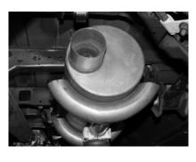
SLIDE MUFFLER ONTO HEADPIPE 1 ½" TO 2". THE INLET IS FACING THE MOTOR. MUFFLER INLET IS LOOKING INTO THE LOUVERS. THE MUFFLER OUTLET SHOULD BE AT THE 9 O'CLOCK POSITION.
