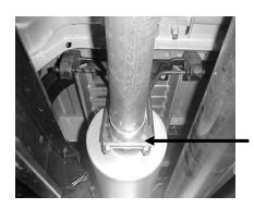
INSTALL MUFFLER # A ONTO THE STOCK HEADPIPE. SUPPORT THE MUFFLER USING A JACK STAND. INSTALL FRONT MUFFLER HANGER #F ONTO THE INLET OF THE MUFFLER. MUFFLER INLET IS LOOKING INTO LOUVERS.
