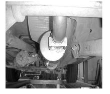
INSTALL THE MUFFLER TO HEADPIPE AND USE CLAMP #E TO ATTACH. PUSH MUFFLER TILL IT HITS THE ALIGNMENT PIN. YOU WILL NEED TO ROTATE THE MUFFLER TO A 2 O'CLOCK POSITION.MUFFLER INLET IS LOOKING INTO THE LOUVERS.
