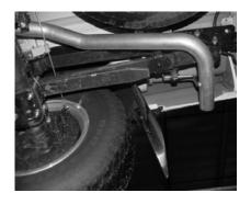
INSTALL THE OVERAXLE TAILPIPE #C INTO THE OUTLET OF THE MUFFLER 1-1/2"-2".
