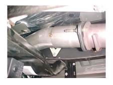
**RE-INSTALL YOUR CATALYTIC CONVERTER TO** THE NEW DOWN PIPE. USING YOU FACTORY NUTS.
