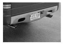
MAKE SURE YOU HAVE A 1" CLEARANCE FROM ALL BRAKE & FUEL LINES, SHOCKS, PIPES, ETC...
