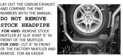
NEXT, INSTALL HANGER **# G TO THE PASSENGER** SIDE OF MUFFLER OUTLET WITH VERTICAL BAR OF THE HANGER TOWARDS PASSENGER SIDE **INSTALL PASSENGER SIDE OVERAXLE PIPE # D INTO** MUFFLER AT LEAST 1 1/2" TO 2".AND USE CLAMP # F TO ATTACH ... DO NOT TIGHTEN
