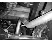
SLIP PASSENGER SIDE OVER AXLE TAILPIPE #C OVER THE OUTLET OF THE MUFFLER 1  $\frac{1}{2}$ TO 2". INSERT THE WELDED HANGER INTO THE FACTORY RUBBER GROMMET, AND ATTACH TO MUFFLER WITH CLAMP # G.
