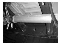
INSTALL HEADPIPE #A ONTO THE FACTORY EXTENSION PIPE. MAKE SURE THAT THE HEADPIPE IS STRAIGHT, NOT ANGLED UP OR DOWN. YOU MAY WANT TO LIGHTLY TAP ON THE END OF THE PIPE TO ENSURE A TIGHT FIT.
