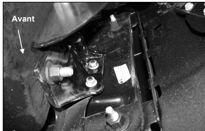
(Fig. 2) Éléments de fixation du crochet de remorquage vus depuis l'arrière du côté droit/passager du pare-chocs
