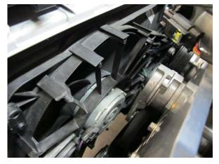
Fig. 2-r: Remove radiator fan assembly
