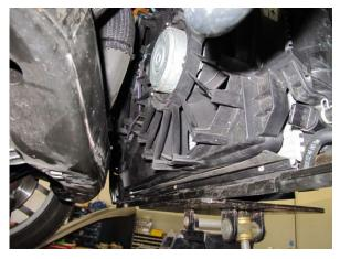
Fig. 2-x: Remove radiator fan assembly
