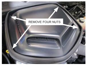
Fig. 2-n: Remove shaker scoop
