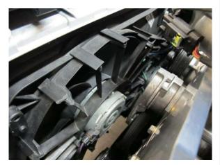
Fig. 4-a: Reinstall radiator fan assembly
