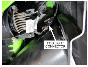
Fig. 2-e: Disconnect fog lights
