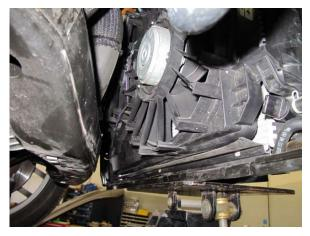
Fig. 2-q: Remove radiator fan assembly
