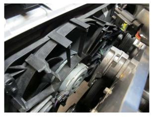
Fig. 2-n: Remove radiator fan assembly
