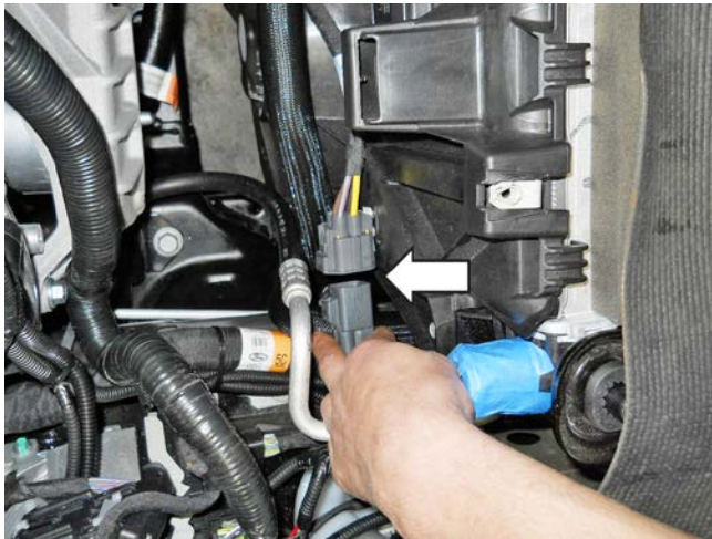
Fan electrical connector
