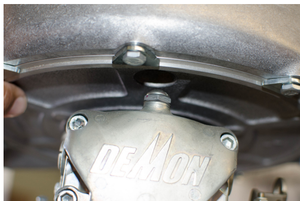
Fig. 3-d: Align Carburetor Hat Reliefs
